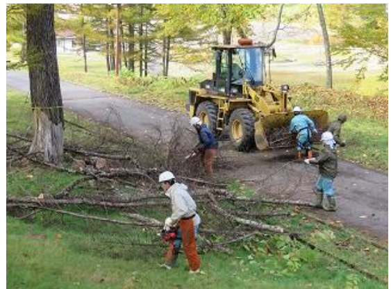
伐採した枝を回収中のタイヤショベル
